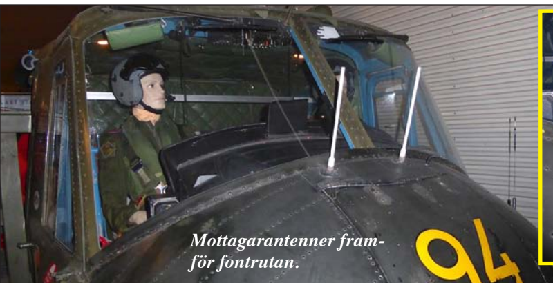
Mottagarantennerna på taket på HKP 3.
