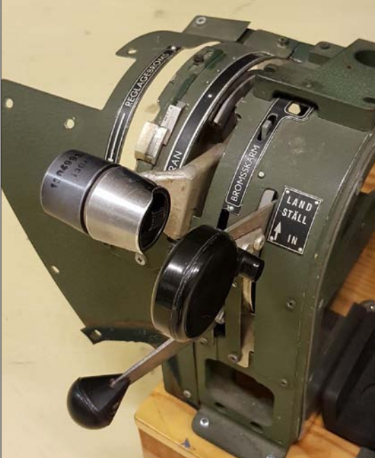
Gasreglage och landställsreglage satt nära.
